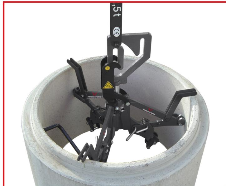
Die Schachtgreifer SchachtFIX 1000 und 1500 eignen sich zum waagerechten Heben, Versetzen und Absenken von Schachtringen DN600 - DN1500 und Schachtkonen sowie Schachtböden DN600 - DN1200. Die Greifer zeichnen sich durch eine hochwertige Verarbeitung sowie durch eine einfache und zuverlässige Handhabung aus..
